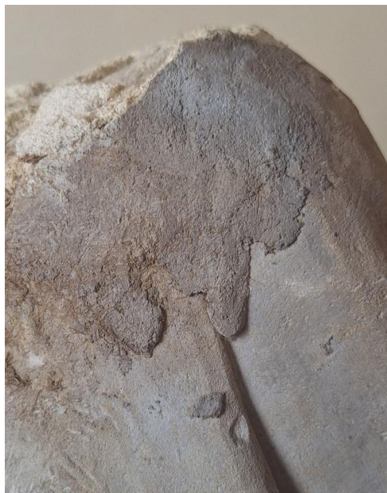
Mortier de ciment gris beige largement débordant au revers
